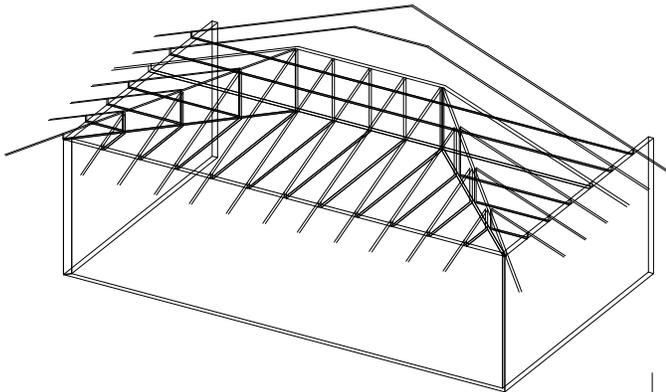
NOTE: MAXIMUM 1/4" GAP ALLOWED BETWEEN END VERTICAL AND GIRDER TRUSS
