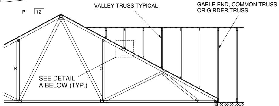
SECURE VALLEY TRUSS W/ ONE ROW OF 16d NAILS 6" O.C.
